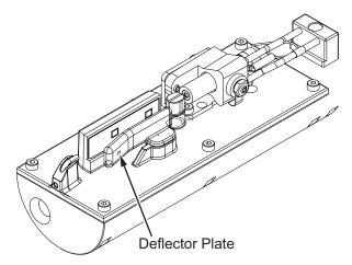
Figure 6-6: Clean the Deflector Plate (Videojet 1620)
