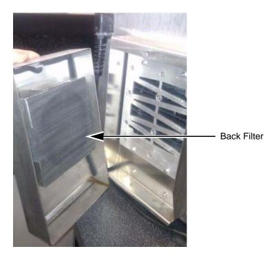
Figure 3-10: Back Filter (IP55 Version) - Videojet 1520
